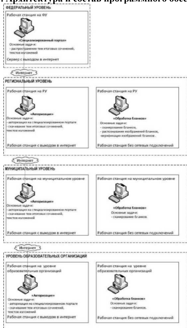
Рисунок 1. Архитектура и состав ПО
